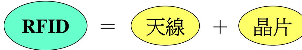
美國 Flint 油墨製造公司子公司 Precisia 全球首創以高速傳統印刷機利用 **導電油墨** 列印 RFID 標籤的天線、然後將預製的晶片自動貼上去，MAN Roland 也表示合作興趣。
